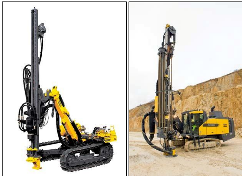
Ilustración 47.- Disposición de equipos de perforación: con martillo en cabeza (izq) y con martillo en fondo (derecha) (MINERAS, 2013)
