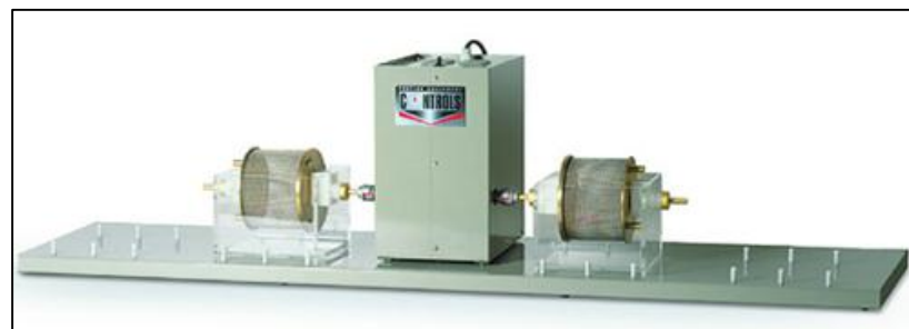
Ilustración 8.- Aparato para medir el desgaste de la roca (Controls, Ensayos de Clasificación)
