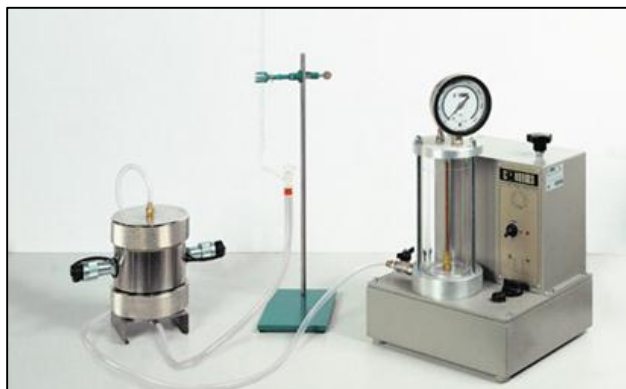
Ilustración 9.- Equipo con célula de Hoek, tapas de permeabilidad, bureta, base y manguito de metal y vidrio (Controls, Permeabilidad de las rocas)
