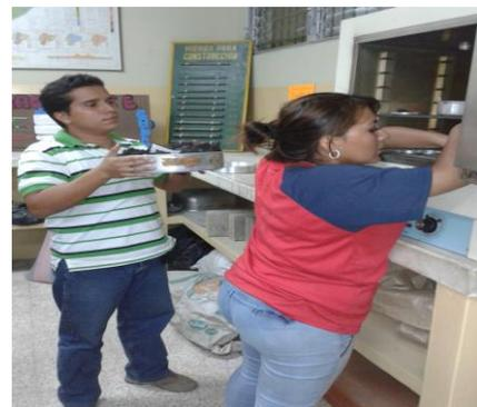
En las imágenes podemos observar que se realizan ensayos de límites mediante la utilización del equipo de Arturo casa grande, así mismo la tamización para la separación de las partículas hasta obtener los finos y llevar al horno eléctrico para su secado respectivo.
