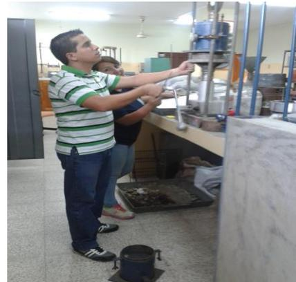
Podemos observar que se realizan los ensayos para proctor y cbr siendo los últimos ensayos para determinar el estudio integral del suelo de la vía.
