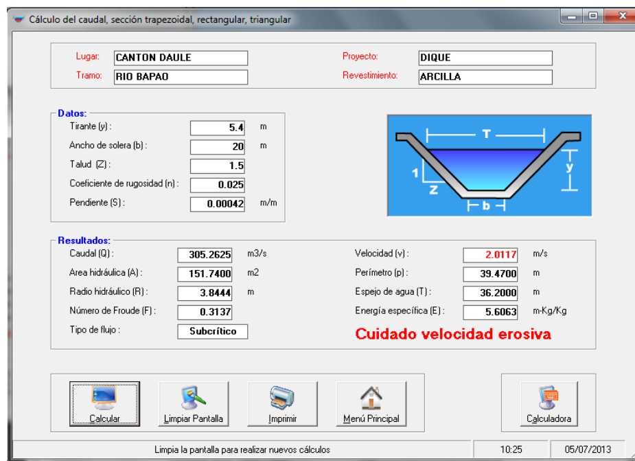
Figura 48. Datos hidráulicos de sección típica de diseño del río Bapao al trabajar con su caudal máximo en un periodo de retorno de 10 años y un bordo libre de 0.15 m.
