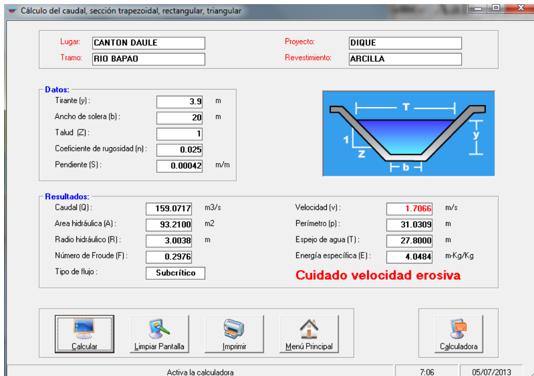
Figura 46. Datos hidráulicos de sección típica (promedio) del río Bapao en la actualidad.
