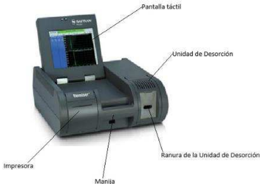
Figura 29. Componentes de una unidad de detección de explosivos
