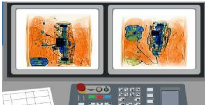
Figura 13. Ejemplo de dos dimensiones en la máquina de rayos X, el contenido interior es difícil de identificar por el ángulo en que están ubicados
