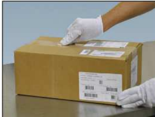
Figura 37. Toma de muestras de trazas de explosivos
