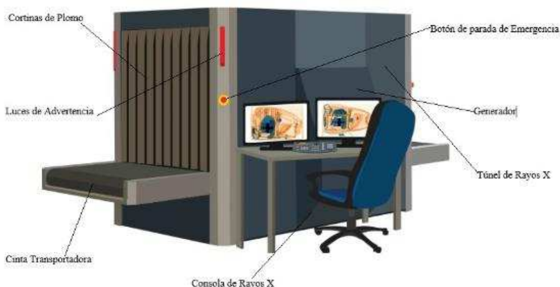
Figura 14. Componentes de una máquina de rayos X
