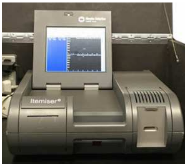
Figura 28. Máquina de Detección de Explosivos (ETD)
