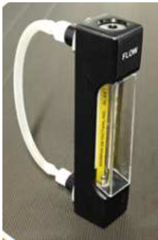
Figura 33. Medidor de Flujos
