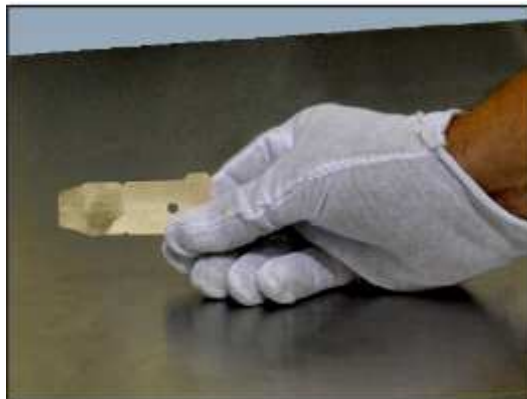
Figura 38. Se deben descartar las trampas sucias para evitar errores en la toma de muestras
