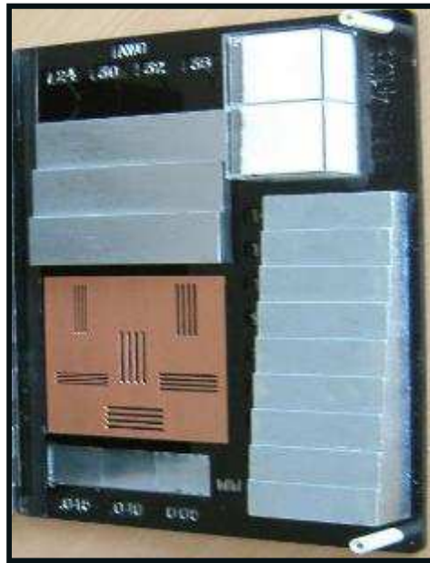
Figura 63. Pieza de prueba estándar (STP) vista interior
